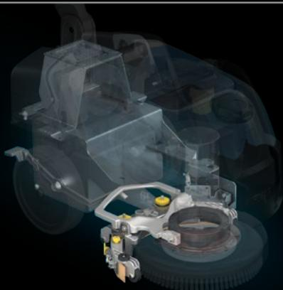
Il tergilavaggio è in alluminio e il telaio è trattato con una vernice anticorrosione, in questo modo GL e GxL sono totalmente protette dall'umidità e conservano nel tempo qualità e prestazioni.
