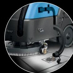
Il serbatoio dell'acqua sporca di GxL si può svuotare anche tramite un pratico tubo laterale
